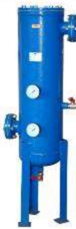
Фильтрационный модуль предназначен для тонкой очистки сжатого воздуха и различных газов, от аэрозолей масла и влаги, а также от твердых частиц размером менее 5 мкм. Обеспечиваемое остаточное содержание аэрозоля масла - менее 4 мг/м³. Используется в системах пневмоуправления и автоматики, пневмоприводе устройств и инструмента для окраски поверхностей распылением.
