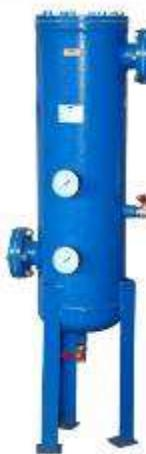
Фильтрационный модуль предназначен для тонкой очистки сжатого воздуха и различных газов, от аэрозолей масла и влаги, а также от твердых частиц размером менее 5 мкм. Обеспечиваемое остаточное содержание аэрозоля масла - менее 4мг/м<sup>3</sup>. Используется в системах пневмоуправления и автоматики, пневмоприводе устройств и инструмента для окраски поверхностей распылением.
