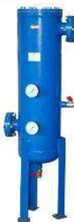
Фильтрационный модуль предназначен для тонкой очистки сжатого воздуха и различных газов, от аэрозолей масла и влаги, а также от твердых частиц размером менее 5 мкм. Обеспечиваемое остаточное содержание аэрозоля масла - менее 4мг/м<sup>3</sup>. Используется в системах пневмоуправления и автоматики, пневмоприводе устройств и инструмента для окраски поверхностей распылением.
