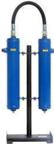
Фильтрационный модуль предназначен для тонкой очистки сжатого воздуха и различных газов от аэрозолей масла и влаги, а также от твердых частиц размером более 3 мкм. Обеспечиваемое остаточное содержание аэрозоля масла - менее 4 мг/м<sup>3</sup>. Используется в системах пневмоуправления и автоматики, пневмоприводе устройств и инструмента для окраски поверхностей распылением.
