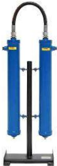
Фильтрационный модуль предназначен для тонкой очистки сжатого воздуха и различных газов от аэрозолей масла и влаги, а также от твердых частиц размером более 3 мкм. Обеспечиваемое остаточное содержание аэрозоля масла - менее 5 мг/м<sup>3</sup>. Используется в системах пневмоуправления и автоматики, пневмоприводе устройств и инструмента для окраски поверхностей распылением.
