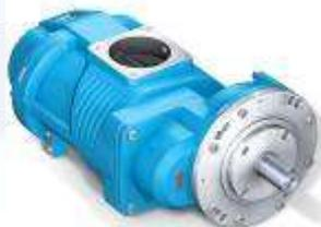
**Винтовой блок EVO15G** производится фабрикой Rotorcomp (Германия) и является основой винтового компрессора. Визуально он представляет собой чугунный корпус, внутри которого на подшипниках размещены два ротора, сжимающие воздух.
