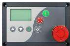
Программируемый многофункциональный контроллер **CMC Airmaster P1** производится в Бельгии. Контроллер Airmaster отображает текущую информацию о состоянии компрессора, о его нагрузке/холостом ходу, времени отключения, аварийных режимах, времени наработки, обеспечивает доступ к настройкам компрессора, а также информирует о предстоящих ТО. Также контроллер Airmaster защищает компрессор и производит его остановку при аварийных ситуациях. Есть возможность дистанционно управлять компрессором.
